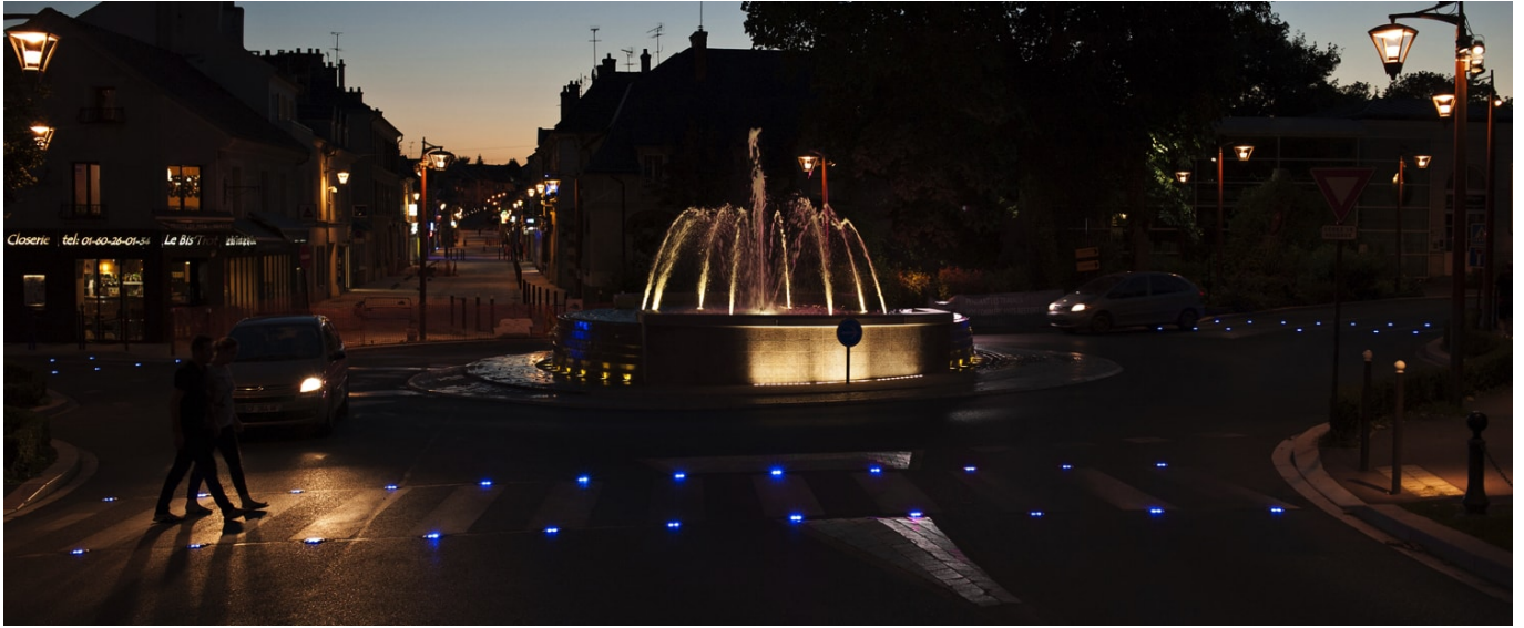
Passage piéton : balise LED routière de sécurité. Passages piétons autour d'un giratoire. Balisage de sécurité des passages piétons à Claye Souilly. Plots routiers LED encastrés ECO-848 (bidirectionnels 2x8 LED bleues fixes). Photographie : Karolina Samborska.
